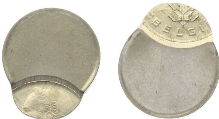
De munt die gedeeltelijk tussen de stempels zat
