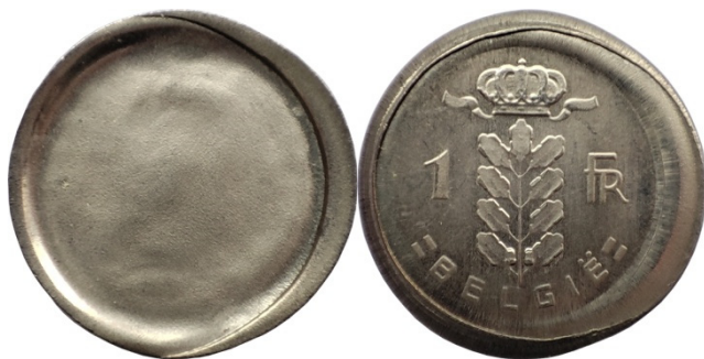
Munt geslagen door een munt dat rond de stempel was geplooid
