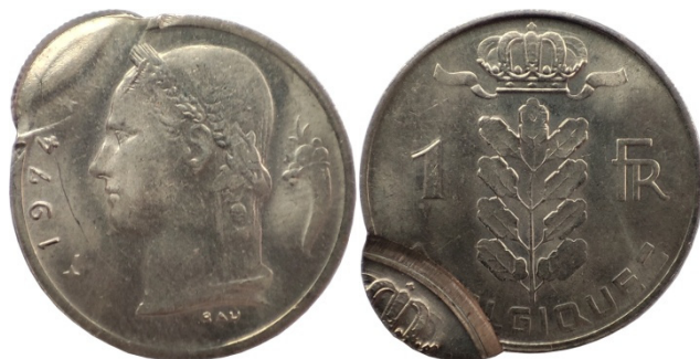
De munt die gedeeltelijk tussen de stempels zat, voor de tweede keer
