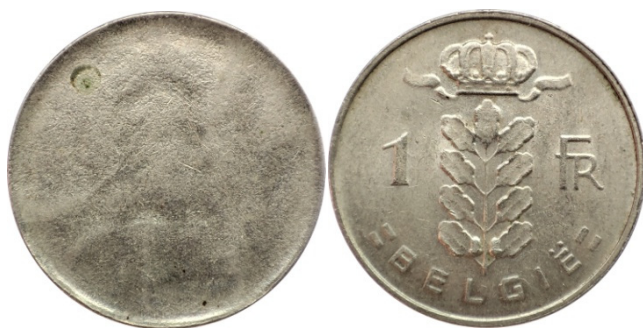
Munt geslagen door een ingekapselde stempel
